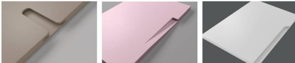
b.前处理：MDF板材四周需进行封边处理，避免在固化过程中发生起泡、开裂现象。
